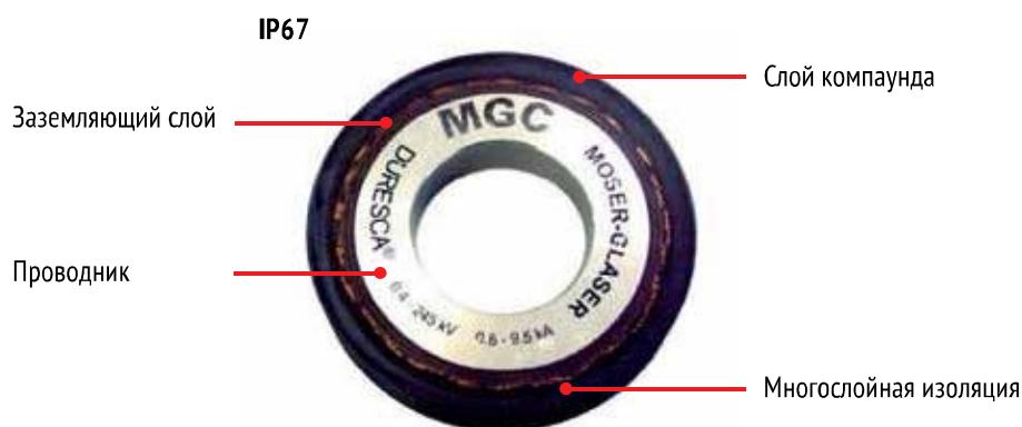
Для исключения возникновения в изоляции частичных разрядов используются полупроводящие слои. Медный заземляющий слой в изоляции гарантирует высокую эксплуатационную безопасность. Заземляющий слой рассчитан на ток короткого замыкания в 8 кА и обеспечивает безопасность персоналу в случае пробоя изоляции. Слой компаунда выполняет функцию защиты от влаги. Снаружи токопровод покрывается защитной трубой из гофрированного полиамида или хромо-никелиевой стали или алюминия.
